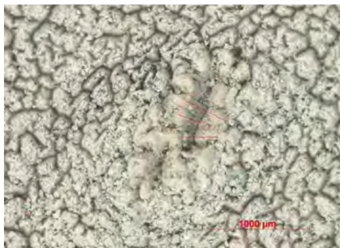
Obr. č. 5 – Povrch zdegradované fólie s odhalenou výztužnou vložkou
