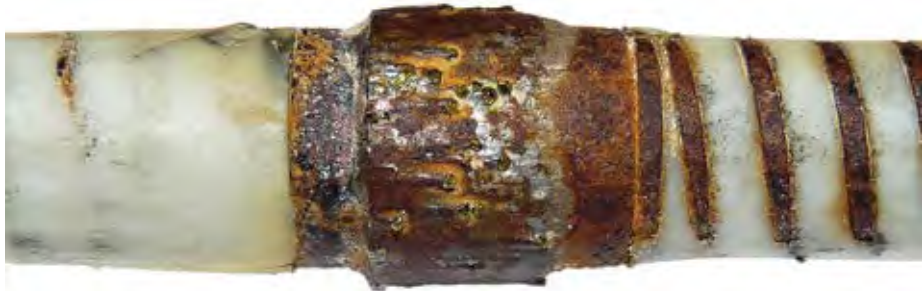
Obr. 3 Priemyselné diamanty na krúžku rezného lana, Španielsko
