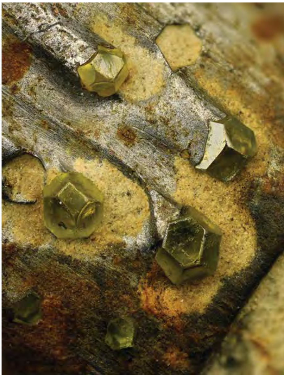
Obr. 2 Priemyselné diamanty na krúžku rezného lana-detail, Španielsko
