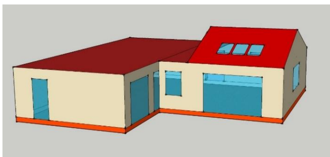
Obr. 1. Model analyzovaného rodinného domu typu bungalow v programe SketchUp a vpravo v simulačnom programe WUFI Plus
