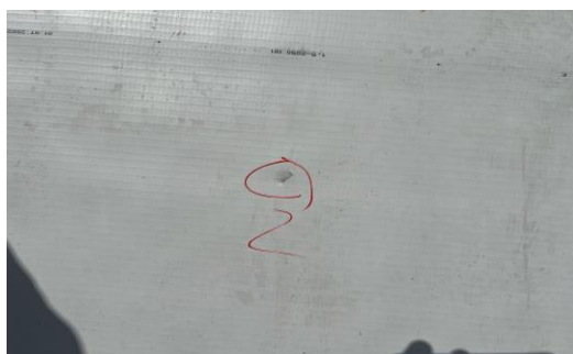
(mechanický prierz detegovaný iskrovou skúškou)
