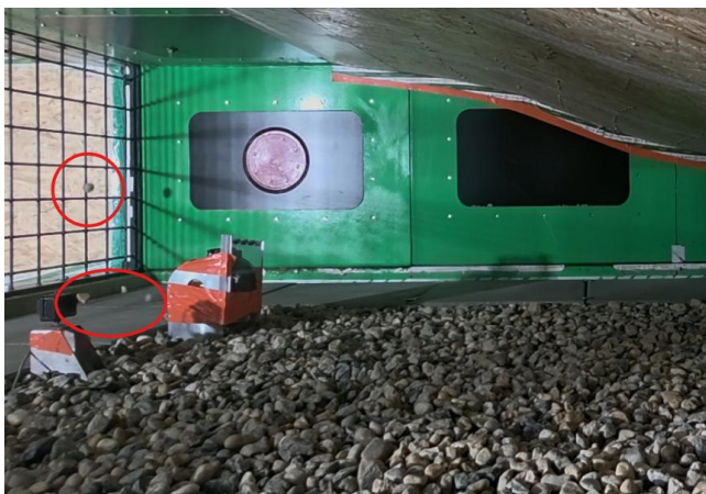
Obr. 9 – Transport zrn kameniva vlivem větru z modelu ploché střechy
