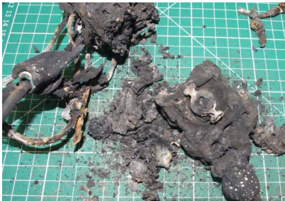
Obrázok 12 Zvyšky DC invertora pri rozoberaní a skúmaní v laboratóriu [9].
