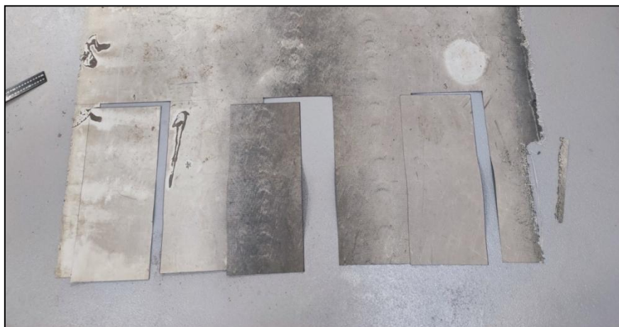
Obr. 7 Odběr podélných pruhů vzorku VZ4, Zdroj: Vlastní
