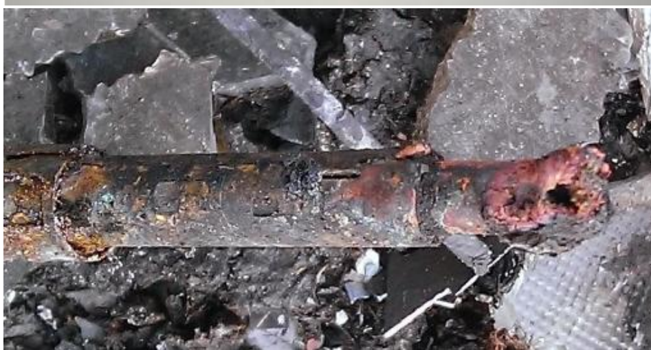
Obrázok 11 Nepoškodený DC konektor (horný obrázok) a príklad kontaktu DC konektora, ktorý bol vystavený elektrickému oblúku (dolný obrázok) [9].
