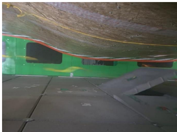
Obr. 10 – Moment kolapsu betonové dlažby umístěné na terčích
