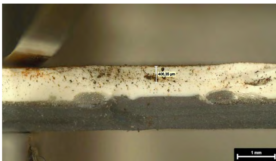
Obr. č. 3 - Rez fóliou v najviac zasiahnutom mieste, tisíce perforovaných miest
