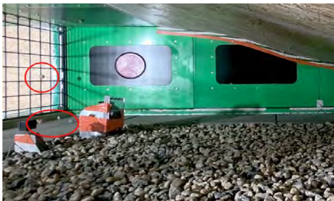
Obr. 9 – Transport zrn kameniva vlivem větru z modelu ploché střechy
